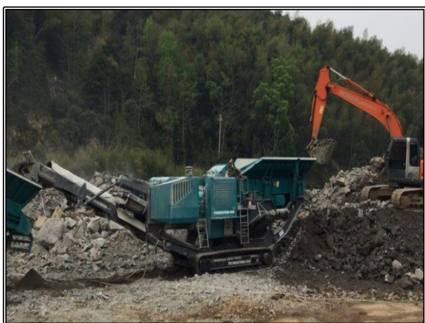
Figura n° 8 - 9 – Tipi di impianti di frantumazione per inerti.
